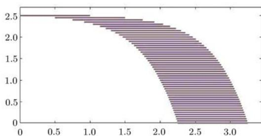
图 3 五十层骨牌堆叠最远延伸模拟结果
