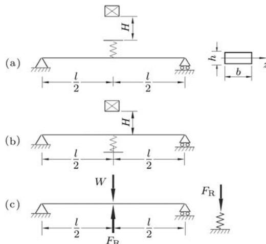
图 2 抗冲击结构受力示意图
