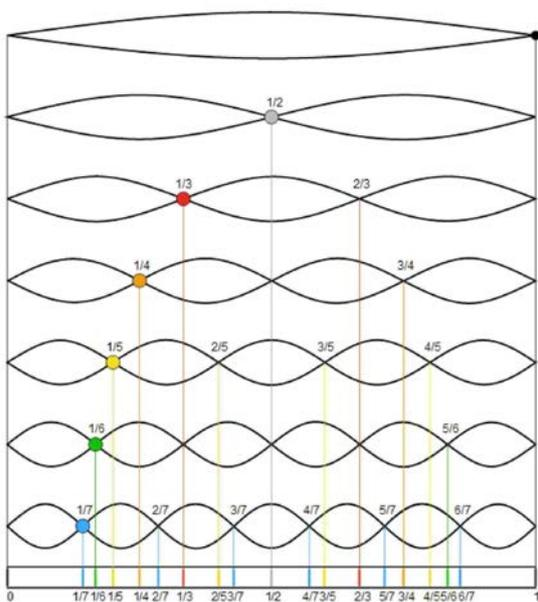
图 1 各不同频率的振动示意图 [4]
